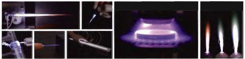
様々なガスで発生した大気圧プラズマ。これらの大気圧プラズマの特徴を活用することによって、ナノ構造材料合成、表面処理、医療応用、廃棄物処理などの革新的プロセッシングへの展開が可能。
